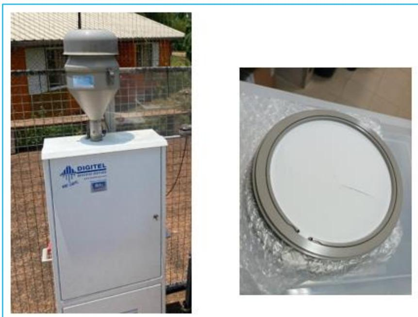
Figure 4 : Préleveur haut débit- DA80 Digital + Filtres quartz 140 mm
