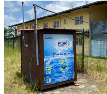
Les stations peuvent être équipées au besoin de différents analyseurs, sous réserve de la disponibilité d'une alimentation électrique.
