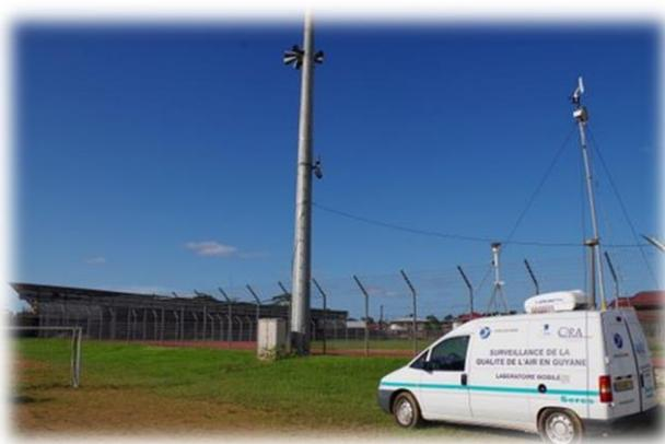
Elle est équipée d'appareils pour la surveillance du NO<sub>x</sub>, NO<sub>2</sub>, NO, O<sub>3</sub> et des PM10, mais peut aussi être équipée pour la mesure du CO ou encore du SO<sub>2</sub>.
